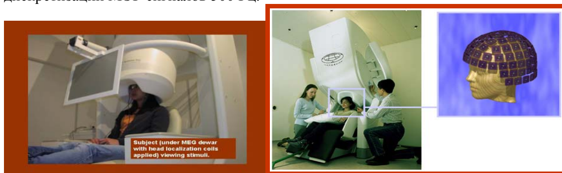
Рис. 1. Установка для измерения МЭГ сигналов и схема размещения СКВИД-сенсоров
